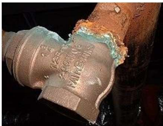
Figure 2 : Corrosion galvanique résultante d'un assemblage de deux métaux différents : robinet en cuivre et conduite en acier galvanisé.
