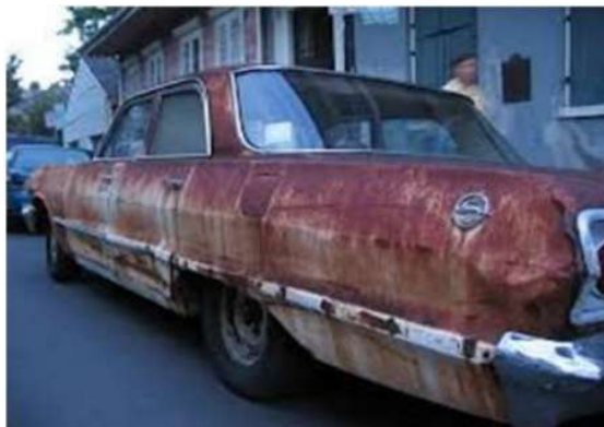
Fig. 1 La corrosion uniforme (exemple : un véhicule corrode).
